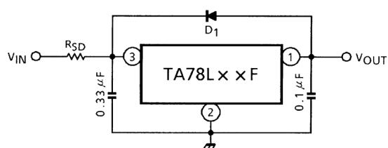
D<sub>1</sub> : IC protective diode
